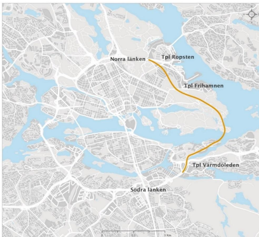
Figur 2. Schematisk översiktsbild av Östlig förbindelse, enligt alternativ med förbindelse i bergtunnel.
