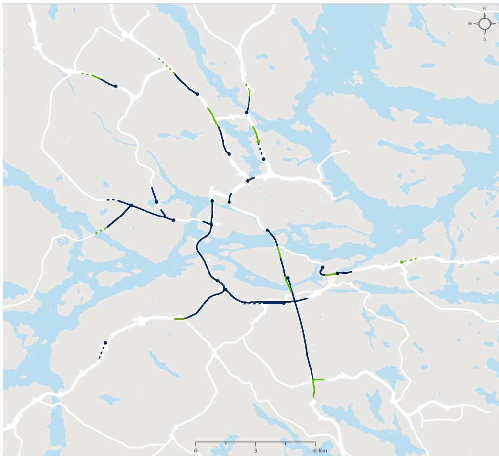
Figur 15. Schematisk illustration av bedömda kölängder för morgonens rusningstrafik med trängselskatt även på innerstadsbroarna (UA1) jämfört med dagens trängselskattesystem (JA1) 40 , utan Förbifart Stockholm och Östlig förbindelse i båda scenarierna. Blå linjer visar kvarvarande köer och gröna linjer visar köer som försvinner. För streckade linjer är bedömningen av framtida kösituationen är osäker (se Figur 6).
