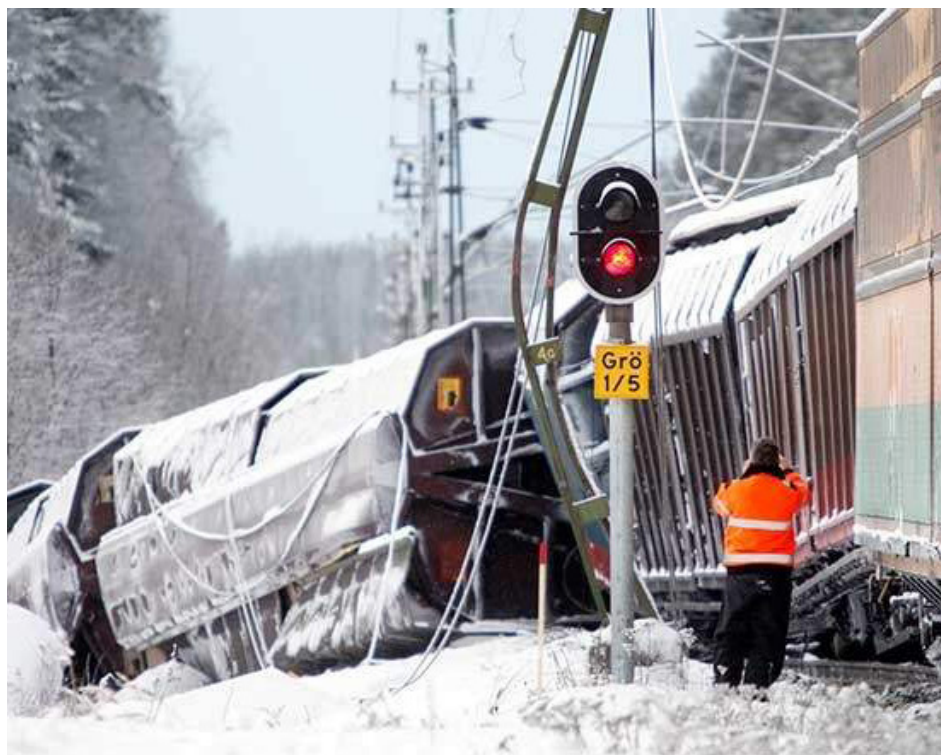
Figur 3.2:6 Urspårningen vid Grötingen 2011 orsakade stora skador för såväl infrastrukturanläggningen som för företagen.
